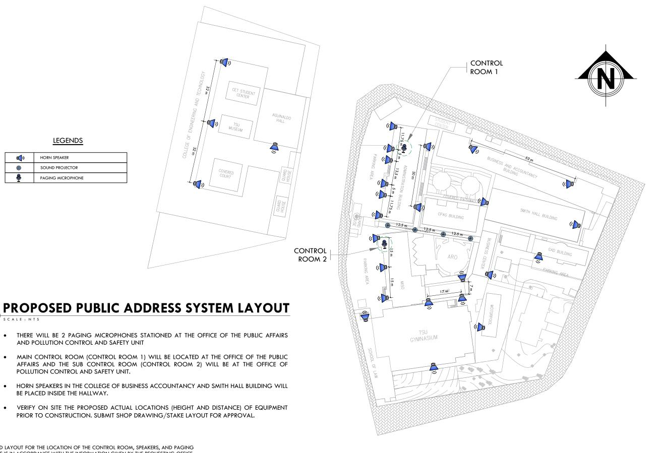
THE PROPOSED LAYOUT FOR THE LOCATION OF THE CONTROL ROOM, SPEAKERS, AND PAGING MICROPHONES IS IN ACCORDANCE WITH THE INFORMATION GIVEN BY THE REQUESTING OFFICE.
